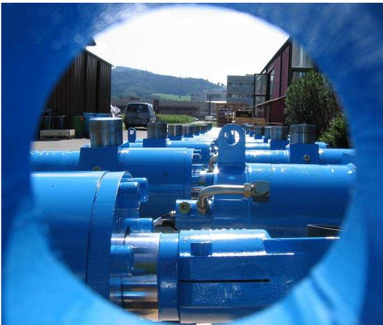
Die Kolbenposition kann nun über ein Wegmesssystem exakt angefahren werden. Zusätzlich kann, wie vom Kunden gewünscht, dort 30 Minuten lang die Position gehalten werden. Mit einer cleveren Lösung konnte die Wasserkühlung an der Stangenaustrittsseite integriert werden. Die Zylinder sind mit doppelwandigen Rohren ausgeführt. Zwischen diesen Rohren fliesst das Kühlwasser, welches die Zylinder über den ganzen Hubbereich kühlt.
