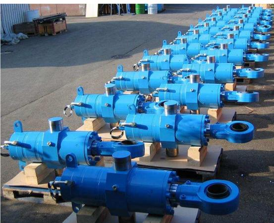
Um grosse Energien abzubauen hat der Zylinder zusätzlich eine beidseitig einstellbare Endlagendämpfung. Die hydraulische Endlagendämpfung ist in der Lage wesentlich höhere Energien aufzunehmen, ohne dass es zu Beschädigungen am Zylinder kommt. Dadurch konnte auf die Überdimensionierung und auch auf die Verwendung externer Stoßdämpfer verzichtet werden.
