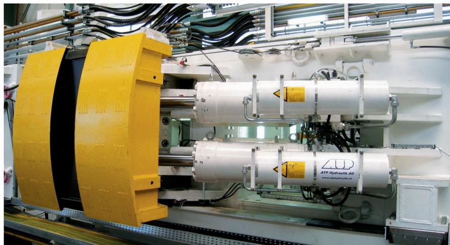
Hydraulikzylinder mit Gripperplatte
