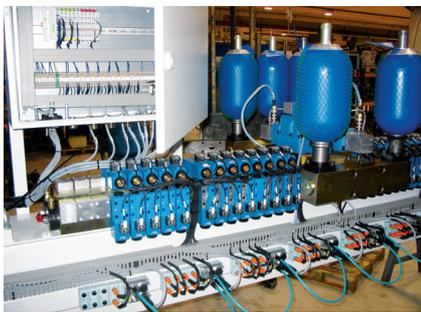
Der Ventil-Balken mit Elektronik
