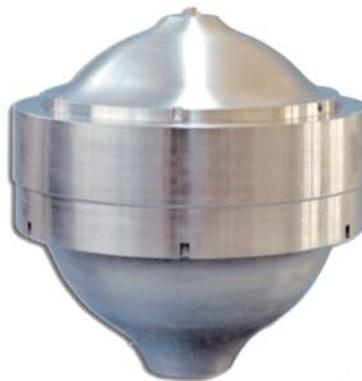
Die kugelförmigen Druckspeicher von LEDUC bestehen aus zwei Halbkugel-Kappen, die miteinander verschraubt sind und dabei eine Membrane einklemmen. Ein in der Membrane eingebauter Metallanschlag schließt bei einer totalen Entleerung die Betriebsöffnung. Hierdurch wird ein Beschädigen der Membrane vermieden.
