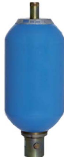
Der Druckspeicher in Flaschenform des Typs ABVE besteht aus dem Körper, der aus geschmiedetem Stahl ist, dem Füllventil, der Blase und dem Mundstück mit einem Ventil ausgestattet, welches ein Auspressen der Blase verhindert, sowie mit einer Entlüftungsschraube, die beim Anlegen des Hydraulikdrucks am System verwendet wird. Die Bauteile dieser Speicher sind mit den wesentlichen im Handel erhältlichen Blasen-Druckspeicher voll austauschbar.
