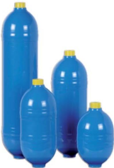
Die geschweissten zylindrischen Druckspeicher des Typs ACS und ACSL bestehen aus einem Körper aus hochfestem Stahl, in dem die Flüssigkeit vom Gas durch eine Blase getrennt wird. Letztere besteht bei den Standardversionen aus Nitril. Bei Anwendungen im Tieftemperaturbereich werden Blasen aus «hydrierten Nitril» eingesetzt.
